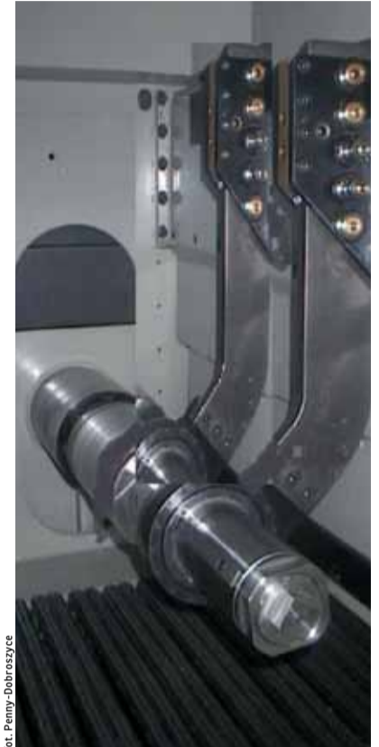
Maszyna Bull 500 LM wyposażona jest w przestawne tuleje, które poszerzają jej możliwości obróbcze.
